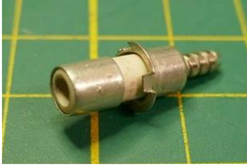
Keramik Rohr-Tauchtrimmer 1,2-8 pF Typ MT-UE Bezug über die Firma Amidon, Link am Ende der Dokumentation
