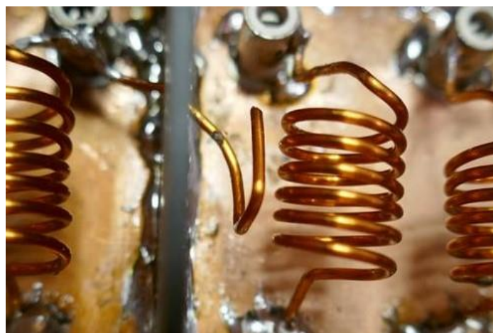
Detail Drahtform Koppelkondensator C5
